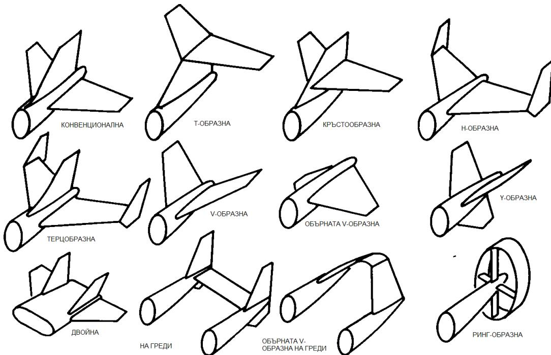
Фиг. 3 Основни типове компоновки на опашните плоскости
